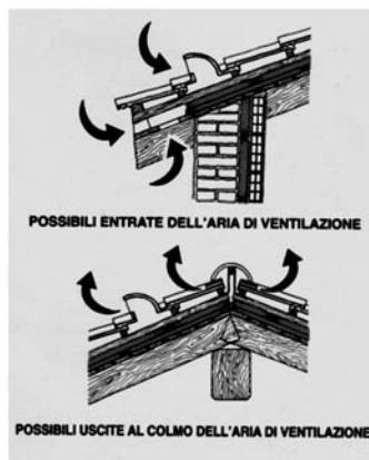
STRATIGRAFIA DI COPERTURA VENTILATA
